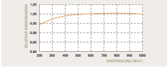
Die typische relative Änderung des Modulwirkungsgrades bei einer Einstrahlung von 200 W/m<sup>2</sup> im Verhältnis zu 1000 W/m<sup>2</sup> beträgt weniger als 6 % (gemessen bei 25 °C, AM 1,5 Spektrum).
